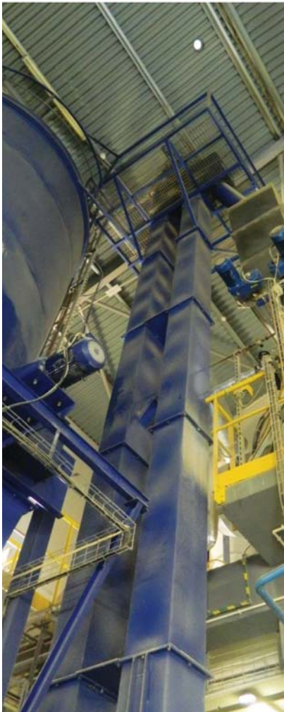
Podajnik kubelkowy trocin przed i po modernizacji
