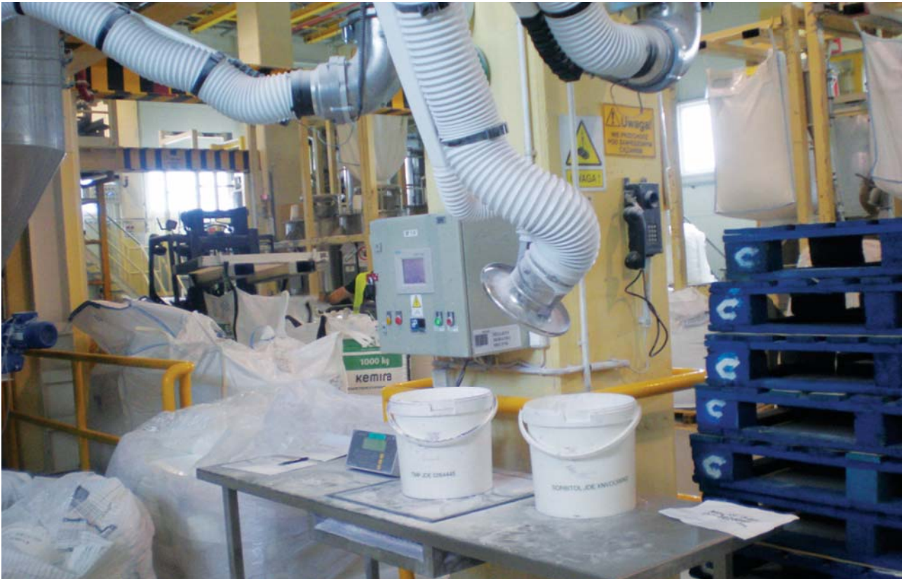
Stanowisko ręcznego naważania proszków
