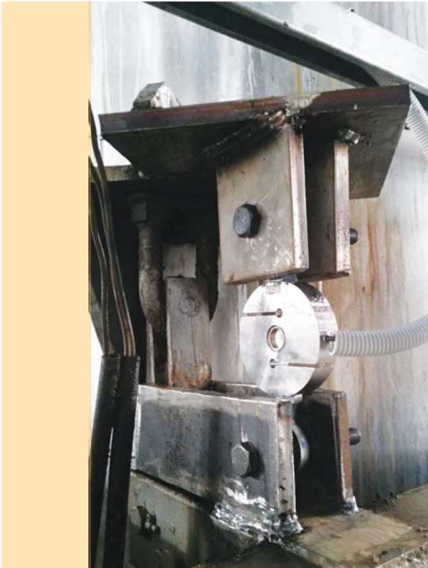
Czujnik tensometryczny w trakcie montażu
